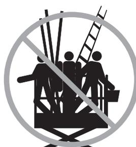
No coloque escaleras ni andamios en la plataforma ni los apoye en ninguna parte de la máquina.
