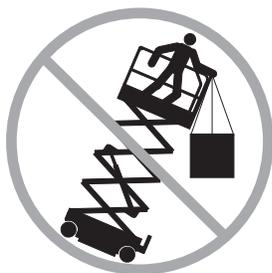
No coloque ni enganche cargas fijas ni sobresalientes a ninguna parte de la máquina.
