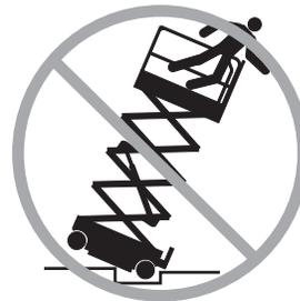
Cuando conduzca la máquina en posición replegada por terrenos irregulares, escombros, superficies inestables o resbaladizas, o cerca de socavones y pendientes, extreme las medidas de precaución y conduzca a velocidad reducida.
