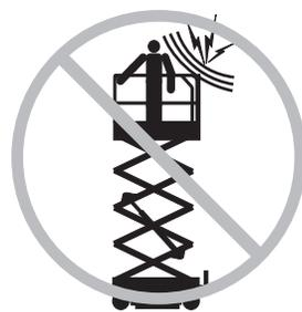
Si la máquina entra en contacto con líneas eléctricas activas, aléjese de ella. Ninguna persona, ya se encuentre en el suelo o en la plataforma, debe tocar ni manejar la máquina hasta que las líneas eléctricas activas hayan sido desconectadas.
