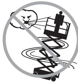
No utilice la máquina con viento fuerte o racheado. No aumente la superficie de la plataforma ni la carga. Cuanto más aumente la superficie expuesta al viento, menor será la estabilidad de la máquina.
