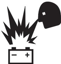
Evite la presencia de chispas, llamas y cigarrillos encendidos cerca de las baterías. Las baterías desprenden gas explosivo.
