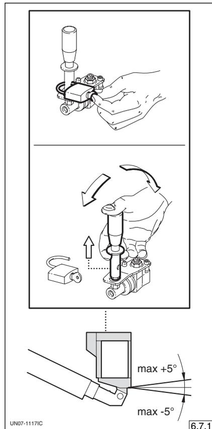
Si la inclinación es superior al máximo permitido ( $\pm 5^\circ$ ) (fig. 6.7.1) corregir manualmente la simetría de la plataforma de trabajo de la siguiente manera.
