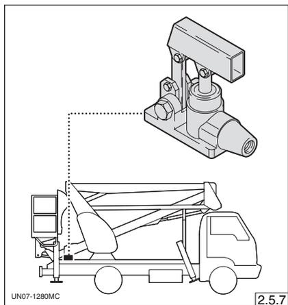
**- Válvulas de mantenimiento de la plataforma de trabajo**
