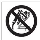
**B2A** - Prohibición de manipulación. Indica la prohibición de efectuar operaciones de soldadura, agujereado, esmerilado o cualquier otra operación que pueda debilitar la estructura sin la autorización del constructor.
