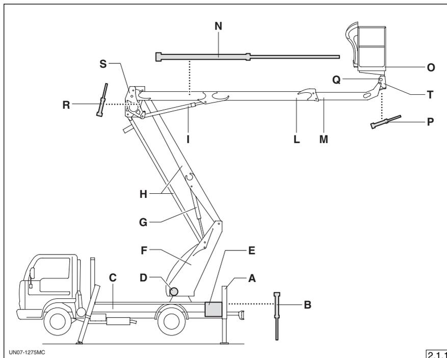
(3) Plataforma de trabajo móvil elevable: subconjunto para el desplazamiento a cuota de personas instalado en un vehículo.
