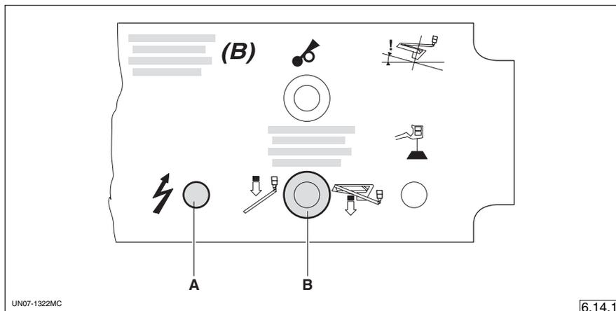
En caso de parada en cuota de la plataforma de trabajo causado por un avería pero con presencia de corriente (indicador luminoso pos. "A" encendido), accionar el interruptor pos. "B" para bajar el brazo telescópico y el brazo articulado.
