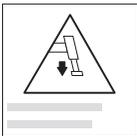
**D7** - Indica la presión máxima ejercitada en el terreno por el estabilizador y la reacción máxima que debe ejercitar el terreno para sostener la máquina.
