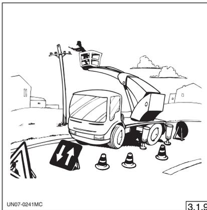
Está prohibido operar con la máquina cuando el viento alcanza una velocidad superior a 12,5 m/seg. (grado 6 de la Escala de Beaufort). Para evaluar la velocidad del viento véase la tabla siguiente.
