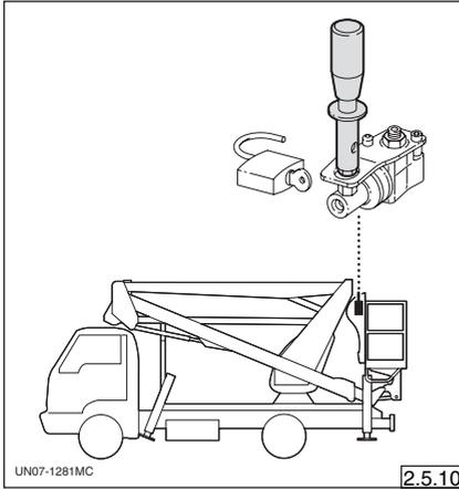
**- Dispositivo limitador de carga en la plataforma de trabajo**
