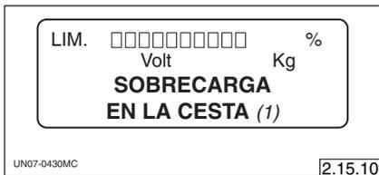
La carga situada en la plataforma de trabajo supera el peso máximo admitido. Retirar de la plataforma la carga excedente.
