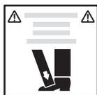
**A2** - Peligro de aplastamiento de las articulaciones inferiores. Indica el peligro de aplastamiento de las articulaciones inferiores causado por los estabilizadores.
