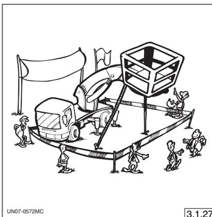
Después de haber estabilizado la máquina, controlar que la placa de cada uno de los estabilizadores se apoye en el suelo correctamente.
