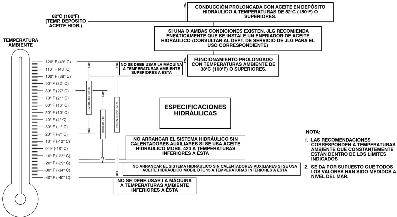
Figura 6-6. Especificaciones de temperaturas de funcionamiento del motor - Caterpillar - Hoja 2 de 2
