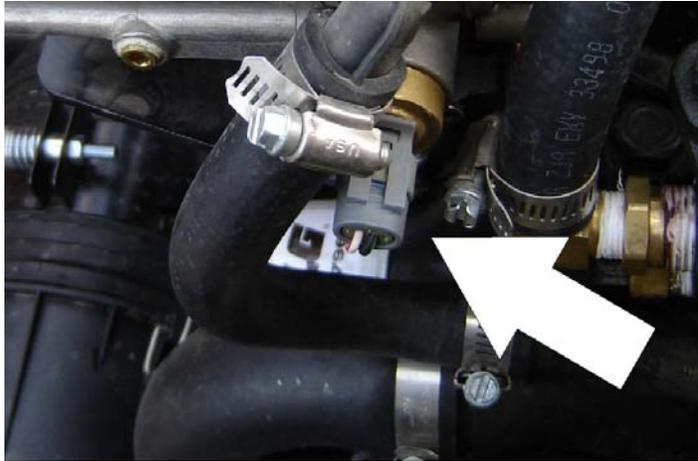
6. Quitar la pinza retenedora del sensor de temperatura de combustible LPG y quitar el sensor del cuerpo del regulador.
