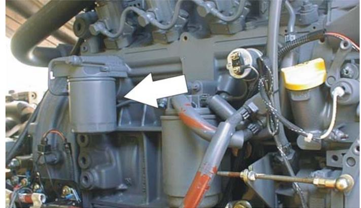
Punto(s) de lubricación - Tapa de llenado/elemento atornillable
