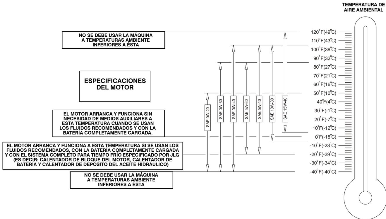
Figura 6-5. Especificaciones de temperaturas de funcionamiento del motor - Caterpillar - Hoja 1 de 2
