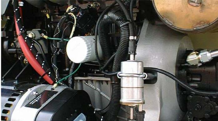
Punto(s) de lubricación - Tapa de llenado/elemento atornillable
