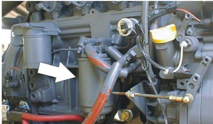
Punto(s) de lubricación - Elemento sustituible
