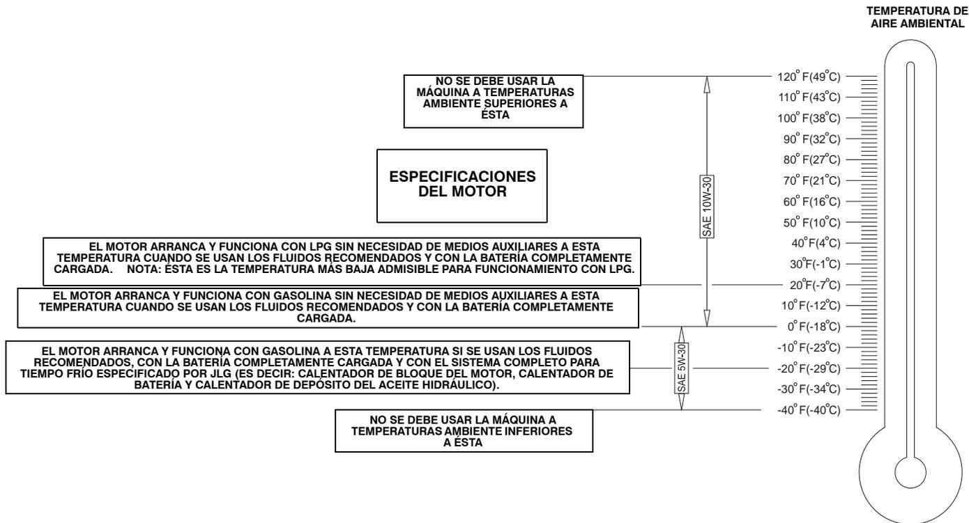
Figura 6-7. Especificaciones de temperaturas de funcionamiento del motor - GM - Hoja 1 de 2
