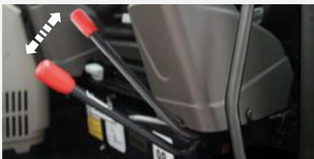
Palanca de seguridad en el acceso al puesto del conductor
