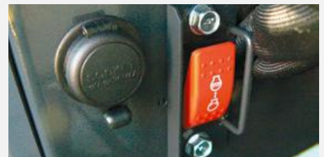
Parada eléctrica del motor (parada de emergencia)
