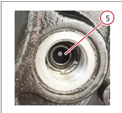
6. Presionar los tornillos Allen pretensados por resorte **5** y girar media vuelta hacia la derecha.
