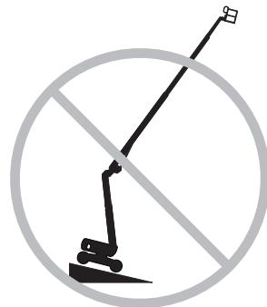
No confíe en la alarma de inclinación como indicador de nivelación. La alarma de inclinación sólo suena cuando la máquina se encuentra en una pendiente muy pronunciada.
