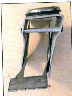
Golpe lateral y deformación del pedal como resultado de un golpe lateral considerable.
