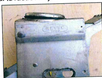
Deformación de la placa superior como resultado de un golpe considerable o de varios golpes menores. Incluso si el resto de la ruedecilla está en buenas condiciones, se debe cambiar.
