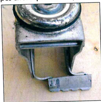
Deformación del pedal como resultado de un golpe frontal considerable, es probable que la placa superior y el cojinete también estén deformados.
