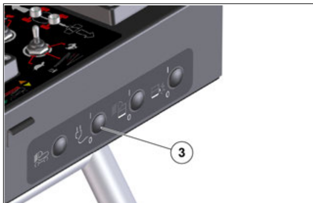
Figura 188: Comprobación del generador eléctrico 3
