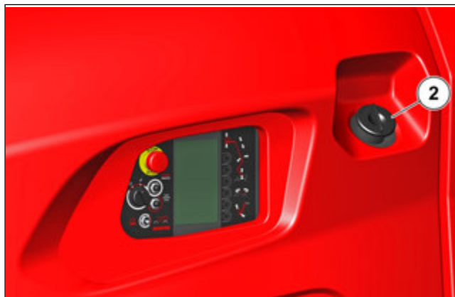
Figura 254: Purga del depósito de combustible 2
