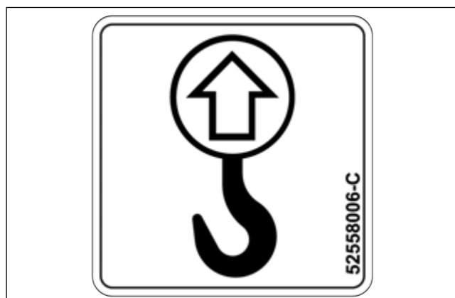
Figura 20: Adhesivo - Punto de elevación
