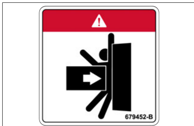
Figura 16: Adhesivo - Peligro y riesgo de aplastamiento
