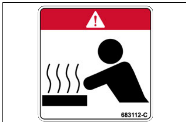
Figura 18: Adhesivo - Peligro y riesgo de quemaduras
