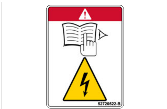
Figura 26: Adhesivo - Peligro y riesgo de electrocución
