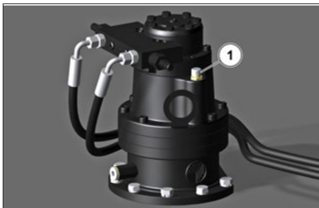
Figura 207: Comprobación del nivel de aceite del motor de rotación de la torreta 1
