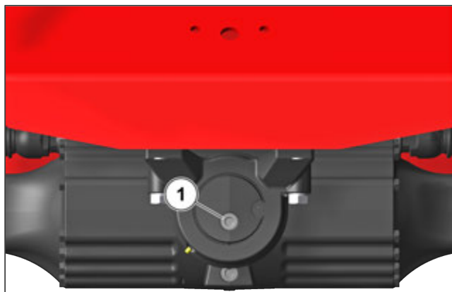
Figura 174: Comprobación del diferencial del eje delantero en busca de fugas
